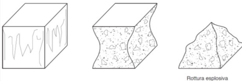
figura 1 Rotture soddisfacenti di provini cubici
