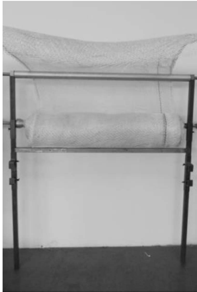
Strumento per l'applicazione all'intradosso del solaio
