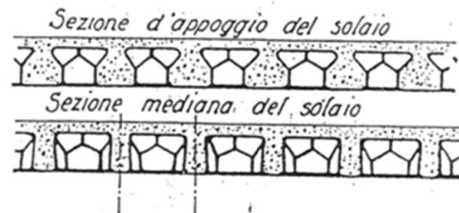
Fig. 225. - Solaio con tavelloni Fadini, con pareti laterali in parte asportabili.
